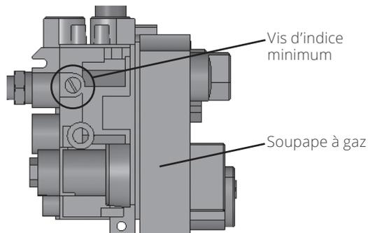
2. Remplacez la vis par celle fournie avec la trousse. Serrez-la à la main avec un tournevis ou une clé Allen selon le cas. Voir les "Spécifications" on page 6 pour vérifier le numéro de la vis qui est estampé sur sa tige.
