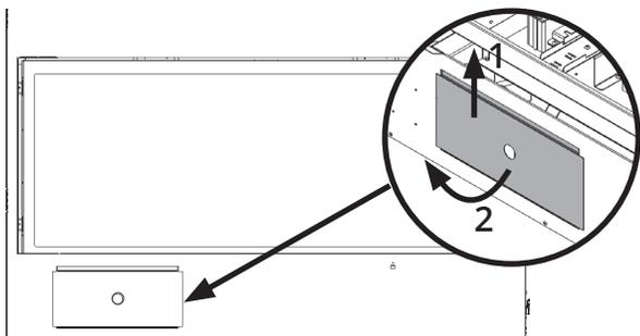
1. Repérez la vis d'indice minimum et enlevez-la (elle peut être recouverte d'une étiquette). Utilisez un tournevis à tête plate ou une clé Allen selon la vis. Une fois enlevée, jetez-la. Notez que la vis est tenue en place par un joint torique de caoutchouc et il peut être nécessaire d'enlever la vis avec des pinces car le joint la tient en place dans la soupape.
