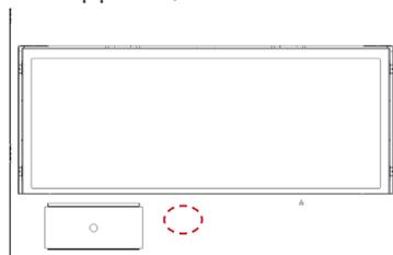
2. Réglez l'aération en glissant le levier vers la gauche ou droite selon le besoin, laissant un espace entre l'obturateur et le trou d'aération en forme de D du bloc de l'injecteur de 7 mm pour le gaz naturel ou de 11 mm pour le gaz propane. Ces dimensions sont la position initiale et peuvent nécessiter un ajustement ultérieur selon le cas. Voir le *Guide d'installation* du foyer pour plus d'information.
