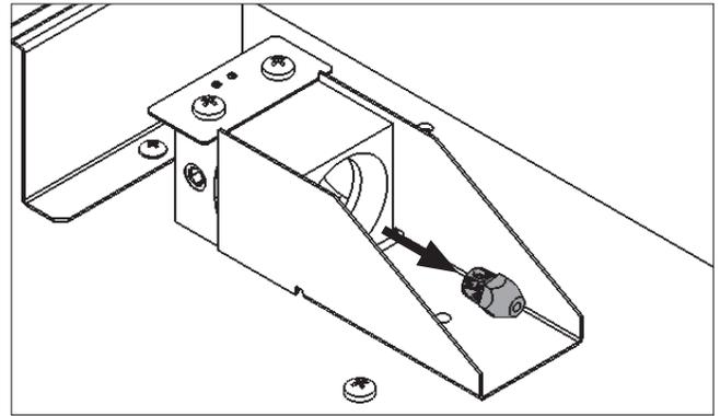
2. Remplacez l'injecteur par celui fourni avec la trousser. Utilisez un scellant de filet de conduite quand vous installez le nouvel injecteur.
