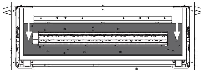
3. Remplacez les panneaux intérieurs et le lit de combustion.
