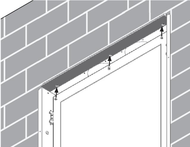
2. Insérez la plaque de finition dans la caisse de l'appareil et poussez-la jusqu'à ce qu'elle touche la finition du mur. Fixez-la avec 4 vis à profile bas noires fournies.
