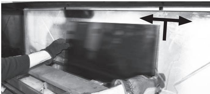
7. Insérez la deuxième section derrière le rail du haut et posez-la dans les rainures des supports du panneau. Glissez la section à l'opposé de la première installée.
