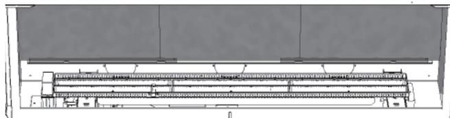
10. En maintenant deux des sections, insérez un support d'ancrage derrière la vis à l'endroit où les deux sections se joignent tel qu'indiqué et serrez la vis pour les fixer.
