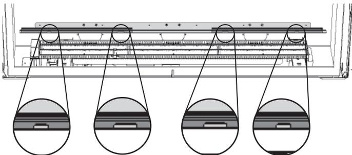
6. Insérez la première section arrière - gauche ou droite - dans la rainure du support. La section gauche dépassera du support vers la gauche et la droite vers la droite; la section du centre chevauchera les deux supports tel qu'indiqué.
