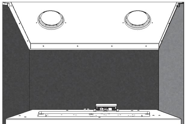
7. Placez le panneau de céramique du haut de façon à ce qu'il repose sur les autres panneaux.
