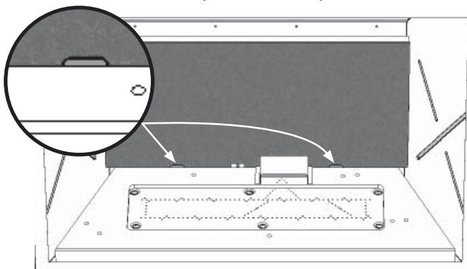
4. Installez un des assemblages de panneaux des côtés en le plaçant contre la paroi de la boîte de foyer. Glissez les panneaux contre les panneaux arrière.
