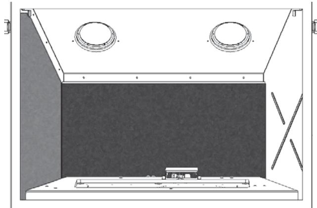
5. Pivotez le support d'ancrage sur les panneaux pour les tenir en place vous assurant qu'ils soient maintenus ensemble. Resserrez la vis du support d'ancrage.
