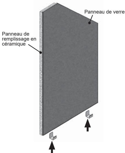
3. Placez le panneau de remplissage arrière sur le rebord de métal contre la paroi arrière de la boîte de foyer; placez par-dessus le panneau de verre, côté lisse visible, vous assurant que les deux panneaux soient retenus par les languettes de retenue. Tenez les panneaux en place.
