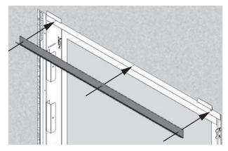
2. Enchâssez la bordure dans l'ouverture de la caisse du foyer en plaçant ses supports des côtés contre les 4 supports de montage de la caisse. Fixez sommairement la bordure avec 4 vis à profile bas. Ajustez la position de la bordure contre la finition du mur et serrez les vis.
