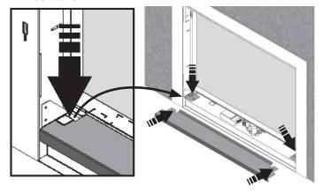
4. Ajustez la position du déflecteur de convection de chaque côté de la fenêtre. Dévissez l'écrou, tirez le déflecteur le plus en avant possible, resserrez l'écrou.
