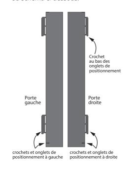
6. Installez la porte gauche en insérant ses onglets de positionnement dans les fentes situées juste derrière le façade de la bordure tel qu'indiqué.
