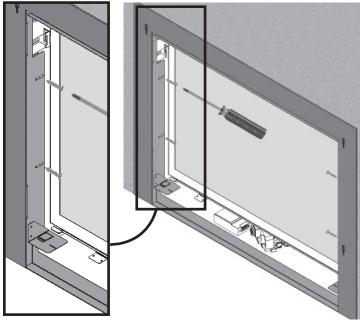
3. Insérez le panneau amovible sous les attaches des supports horizontaux des côtés et poussez le panneau jusqu'à ce qu'il soit égal à la surface de la bordure.
