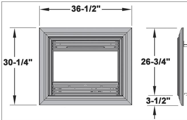
Les Bordures à 4 côtés 748CTK (noire) et 749DTK Deluxe (noire) sont conçues pour être installées avec une des bordures intérieures sur les foyers Valor G3 738 ou 739, ou sur le Retrofire RF24B lorsqu'installé dans la Caisse à dégagement zéro RA24ZC.
