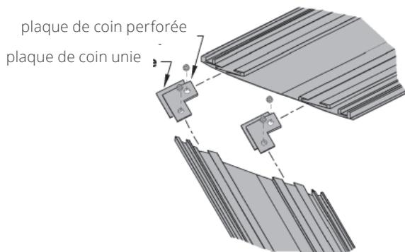
2. Fixez les supports de montage aux deux côtés de la bordure à l'aide de 3 vis par côté. Le bas des supports doit être aligné aux coins intérieurs de la bordure.
