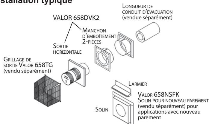
Tout parcours horizontal des conduits doit être élevé de 1/4 po (7 mm) pour chaque portion de 1 pi (30 cm) dans la direction du courant d'évacuation. Le dernier conduit avant la sortie peut être incliné vers le bas afin de permettre le drainage.
