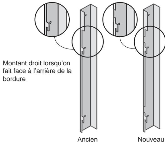
4. Installez les nouveaux montants à l'arrière de la bordure (3 écrous par côté) (709 seulement).
