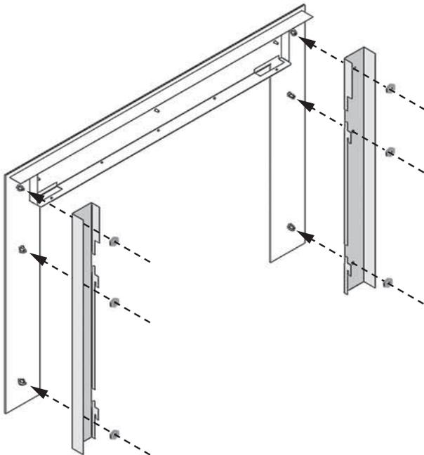
5. Accorchez la grille de protection sur l'arrière de la bordure. Orientez-la de façon à ce que ses languettes de fixation soient vers l'arrière.
