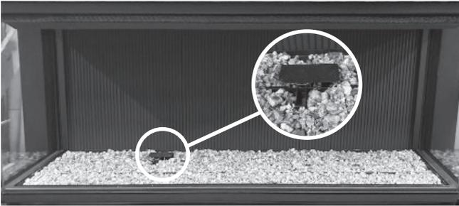
3. Enlevez la vermiculite et repérez les trous dans la plateforme à gauche de la veilleuse et placez-y la bûche L40 insérant ses deux chevilles dans ces trous.
