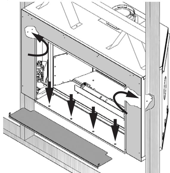
4. L'appareil installé avec la Bordure à 4 côtés 1365 ou la Bordure de verre 1370 ne requiert pas de plaque de seuil. Jetez ou recyclez la plaque de seuil.
